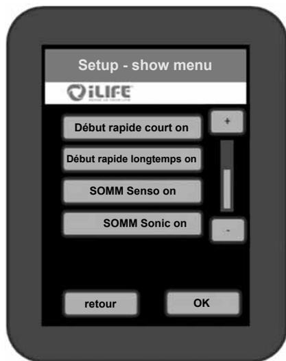
Illustration 33: Les points du menu sélectionnés qui doivent être visibles apparaissent avec un bord doré
