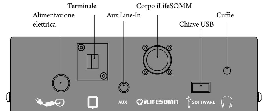
Figura 4: Connessioni presso l'unità di controllo centrale
